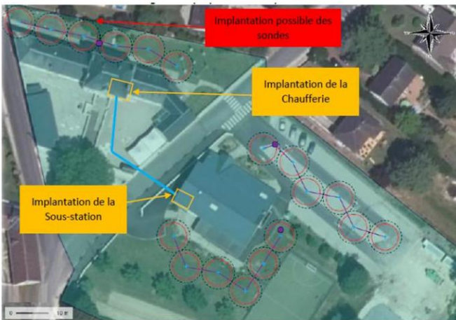
Figure 18 : Proposition d'implantation de la chaufferie et du champ de sondes – Source : HGC
